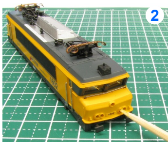
2 Druk de lichtgeleiders uit de kap doormiddel van een satéprikker.
