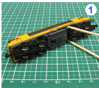
1 Het openen van de kap met behulp van twee satéprikkers.
